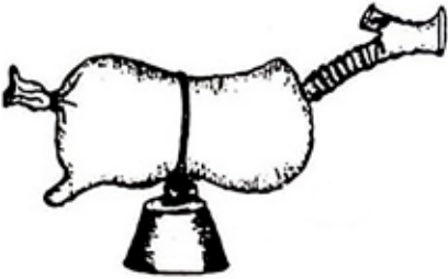
Het derde SCUBA-ontwerp van Florencio Valangren waarmee een een geofefende vrijduiker op een diepte van 6 m vijftien minuten kan verblijven.
