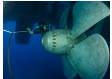
Inspectie van de schroef.
